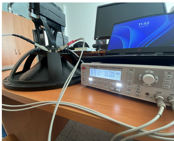
Obrázek 29: Měření cívek na můstku - Fotografie
