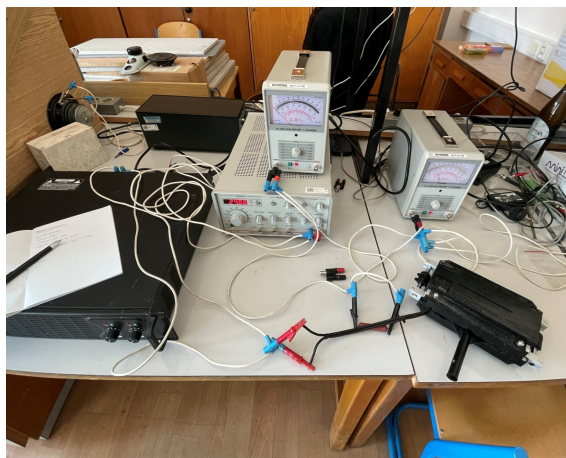
Obrázek 32: Měření impedance motoru bez membrány - Fotografie
