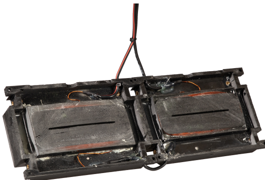
Obrázek 21: 3D vytisknutý model primárního dílu s navinutými cívkami zalité epoxidem
